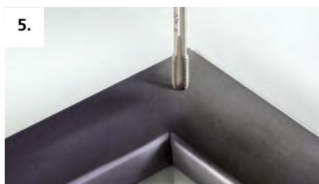
5. Roscar con un macho ISO M6 según DIN 13-1 en el orificio
