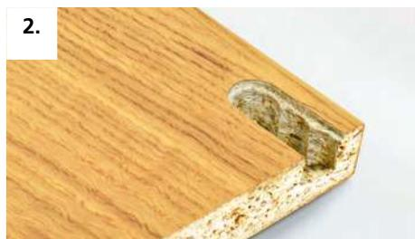
2. Fresar o perforar elementos de ensamble en la máquina CNC
