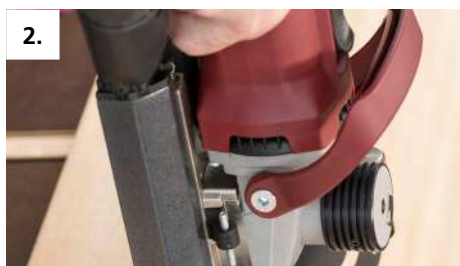
2. Fresa en el canto con la placa auxiliar de 2 mm (profundidad de fresado de 12 mm)
