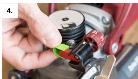
4. Colocar la pieza adicional de ajuste de profundidad P-System de 4 mm (profundidad de fresado eficaz de 8 mm)
