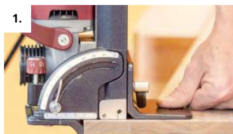
1. Fresar la ranura P-System con el ajuste P-14
